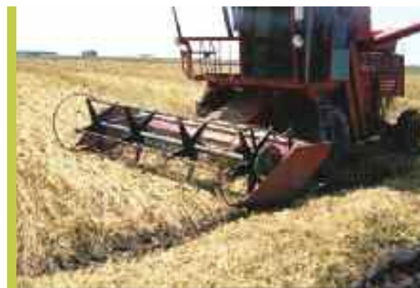
FOTOG. 6 | LAS PRIMERAS COSECHADORAS CON CABINA MODIFICADAS POR TALLERES LOCALES INCORPORÁNDOLE TRACCIÓN EN EL EJE TRASERO
