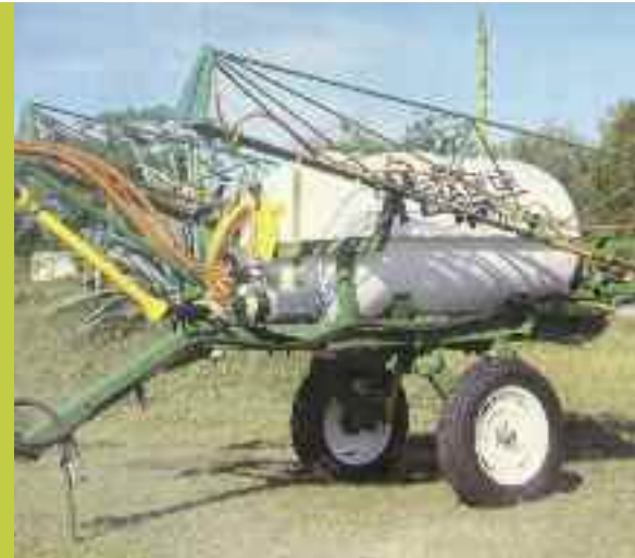
1971 | PULVERIZADORA DE ARRASTRE METALFOR DE 2000 LITROS, BARRAL DE 18 M
