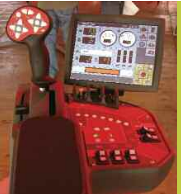
2008 | TABLERO ELECTRÓNICO VASSALLI AXIAL AX 7500 | ALTO DESARROLLO TECNOLÓGICO, MONITOR DE RENDIMIENTO, JOYSTICK DE COMANDO CENTRALIZADO, PANTALLA DE CUARZO LÍQUIDO ACTIVA | TODO ELLO POSIBILITÓ VENDER LA PATENTE DE ESTA COSECHADORA A SAME DEUTZ FAHR
