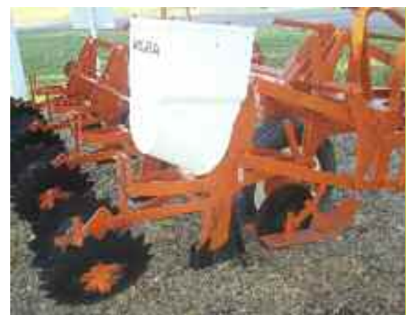
SEMBRADORA MIGRA PARA SIEMBRA DIRECTA UTILIZADA EN LOS ENSAYOS DE LABRANZA DE LARGA DURACIÓN DESDE EL AÑO 1976 EN LA ESTACIÓN EXPERIMENTAL AGROPECUARIA INTA MARCOS JUÁREZ | CUCHILLA DE CORTE CON PATÍN LIMITADOR DE PROFUNDIDAD, AZADÓN CON QUILLA DE SUCCIÓN, RUEDA APRETADORA DE SEMILLA Y DOBLE DISCO ESCOTADO COMO TAPADOR | DISTRIBUIDOR DE SEMILLA CON PLACA INCLINADA, UN HITO PARA LA SIEMBRA DIRECTA EN GRANO GRUESO
