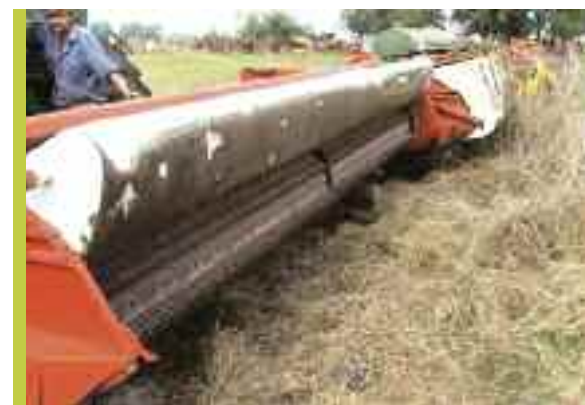
FOTOG. 9 | CABEZAL STRIPPER
