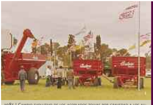
1985 | CAMBIO EVOLUTIVO DE LOS ACOPLADOS TOLVAS POR GRAVEDAD A LOS AUTODESCARGABLES CON TDP | FACILIDAD DE MOVIMIENTO DEL GRANO DESDE LA TOLVA AL CAMIÓN Y MAYOR CAPACIDAD DE CARGA
