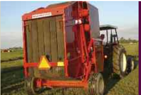
1997-98 | ENFARDADORA PRISMÁTICA GIGANTE, FARDO DE 500 KG | EN 1997 EL INTA PROPEFO REALIZA UN ENSAYO COMPARATIVO ENTRE UNA ROTOENFARDADORA Y UNA ENFARDADORA GIGANTE (VENTAJAS A FAVOR DEL FARDO GIGANTE, POR CALIDAD Y CAPACIDAD DE TRABAJO)
