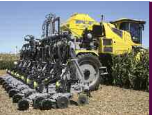
2007 | SEMBRADORA AUTOPROPULSADA PLA CON SISTEMA DE INTERSIEMBRA CHOLET PARA EL MANEJO DE INTERCULTIVOS DE GRANO GRUESO (SIEMBRA DE SOJA EN DOBLE HILERA A 35 CM EN MAÍZ EN FLORACIÓN A 1,05 M)
