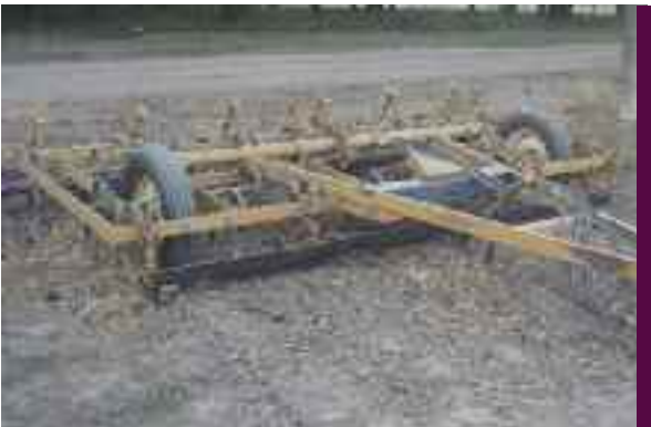
1985 | DIFUSIÓN DEL VIBROCULTIVADOR PARA PREPARACIÓN DE CAMA DE SIEMBRA, RABASTO NIVELADOR, BRAZOS EN "S" VIBRADORES Y ROLLO DESTERCONADOR
