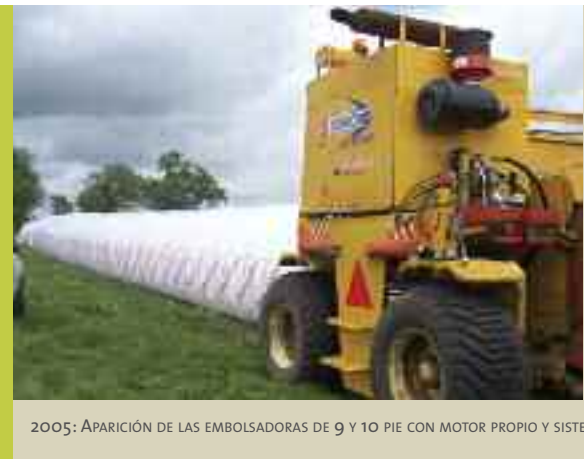
2005: APARICIÓN DE LAS EMBOLSADORAS DE 9 Y 10 PIE CON MOTOR PROPIO Y SISTEMA AUTOPROPULSADO HIDROSTÁTICO
