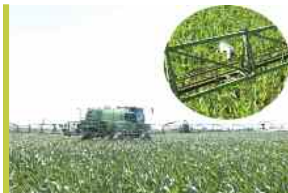
2006/07 | PULVERIZADORA/FERTILIZADORA AUTOPROPULSADA, CHORREADOTA DE UAN CON SENSORES INFRARROJOS ACTIVOS DE LECTURA DE NDVI (GREEN SEEKER) PARA APLICACIÓN VARIABLE SEGÚN AMBIENTE | METALFOR/D&E/INTA PARANÁ
