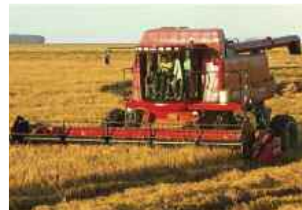
FOTOG. 14 | COSECHADORA ESPECÍFICA ARROCERA DE TRILLA Y SEPARACIÓN AXIAL
