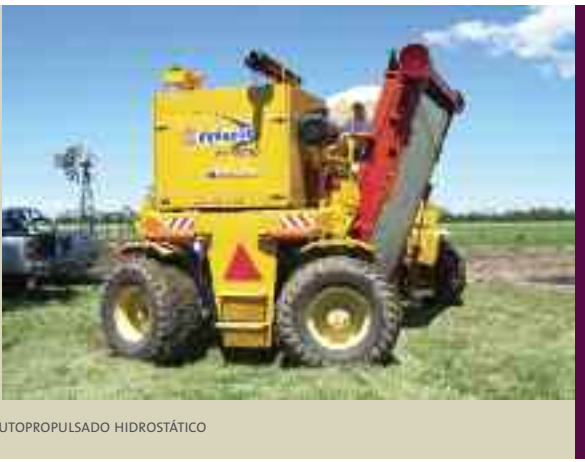
2005: APARICIÓN DE LAS EMBOLSADORAS DE 9 Y 10 PIE CON MOTOR PROPIO Y SISTEMA AUTOPROPULSADO HIDROSTÁTICO
