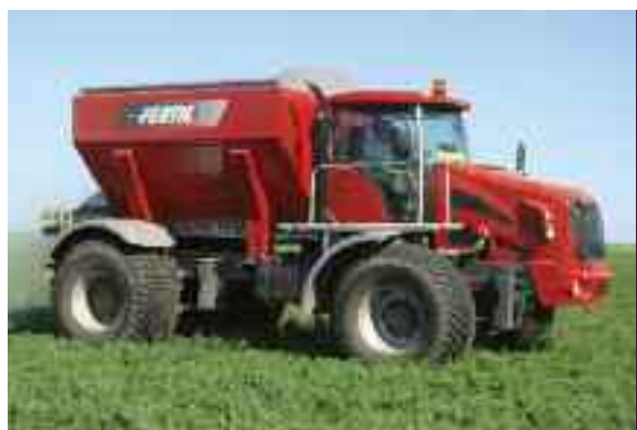
2009 | FERTILIZADORA - ENCALADORA AUTOPROPULSADA, 10.000 LTS DE CAPAC. DE TOLVA, DOSIFICADOR POR CINTA TRANSPORTADORA DE VELOCIDAD VARIABLE, CONTROL DE DOSIS SISTEMA OLEOHIDRÁULICO, TASA VARIABLE (VRT) EN FUNCIÓN DE MAPA DE PRESCRIPCIÓN | NEUMÁTICOS DE ALTA FLOTACIÓN, SUSPENSIÓN NEUMÁTICA Y MOTOR DE 285 CV | EMPRESA FÉRTIL DE MARCOS JUÁREZ
