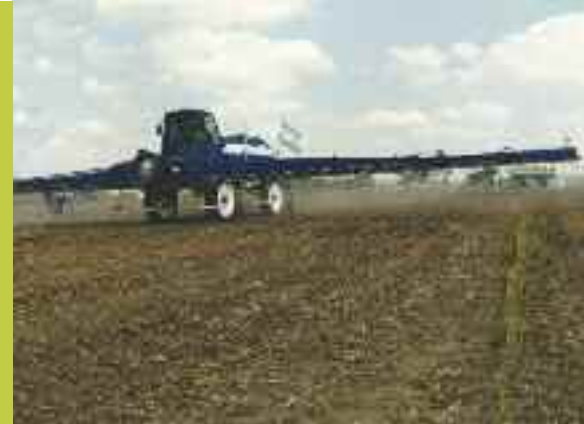
1994. PRIMEROS PULVERIZADORES AUTOPROPULSADOS CON BARRALES EQUIPADOS CON TÚNEL DE VIENTO, COMPUTADORA Y SUSPENSIÓN NEUMÁTICA
