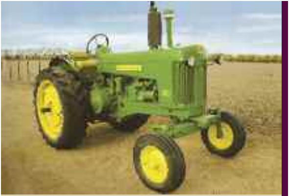
TRACTOR JOHN DEERE 730, 62 HP | FABRICADO EN ARGENTINA DURANTE 1959 – 1971
