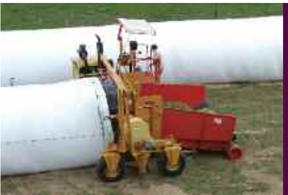
1999 | EMBOLSADORAS DE 9 PIE, FABRICADO EN ARGENTINA, CON MOTOR PROPIO Y DESCARGA FRONTAL.
