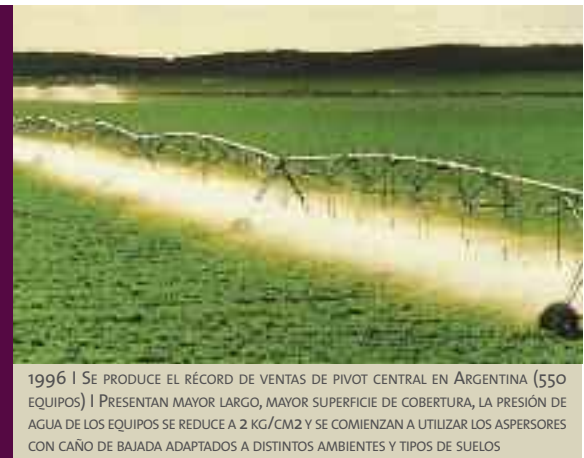
Nuevos aspersores de baja presión, mayor eficiencia del uso del agua y mejor infiltración en todo tipo de suelo
