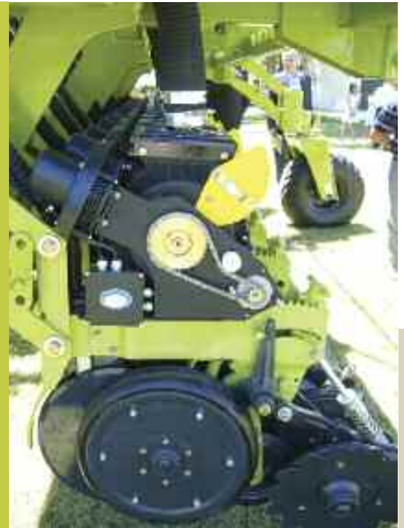
2009 | SEMBRADORA DE GRANO GRUESO NEUMÁTICA SCHIARRE CON MOTOR ELÉCTRICO DE ACCIONAMIENTO DE TURBINA Y MOTOR ELÉCTRICO DE MANDO CINEMÁTICO EN CADA CUERPO. DOSIS VARIABLE DE SEMILLA Y FERTILIZANTE, SISTEMA CAN BUS, TODO ACCIONADO ELÉCTRICAMENTE
