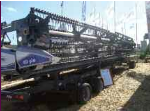
2009 | CABEZAL DE SOJA/TRIGO, DE 40 PIES DE ANCHO DE CORTE CON ALIMENTACIÓN POR LONAS, SUPENDIDO SOBRE DOS RUEDAS CON SUSPENSIÓN NEUMÁTICAS | EMPRESA PIER-SANTI PLATAFORMAS
