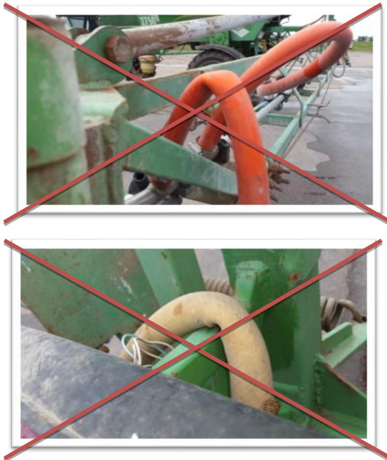
Fig. 26: Las tuberías presentan curvaturas pronunciadas con rozamiento sobre otras superficies.
