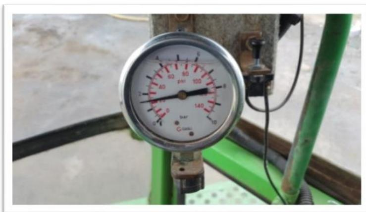
Fig 4: El manómetro debe estar visible para evaluar la presencia de pulsaciones.
