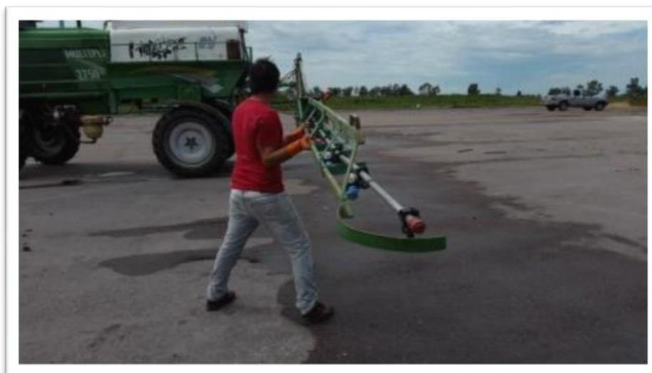
Fig. 29: Se comprobará que al ejercer una presión sobre la barra esta retorne a su posición original.
