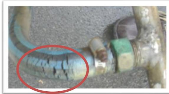
Fig. 25: La manguera se observa desgastada, lo que podría generar futuras fugas. Se recomienda un cambio de la misma.
