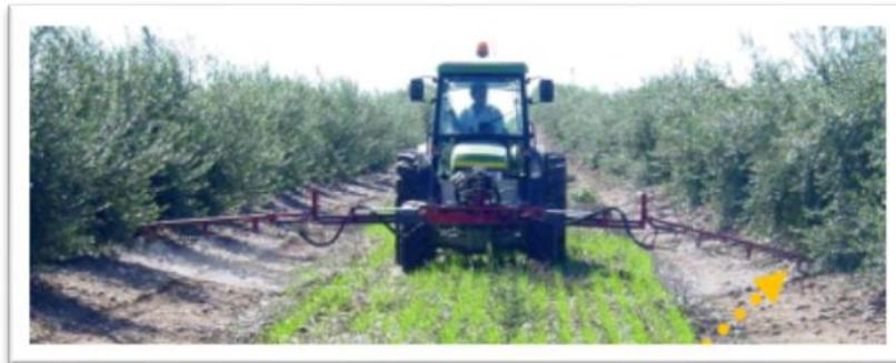
Fig. 28: La barra no presenta una completa horizontalidad. Ni uniformidad de altura.
