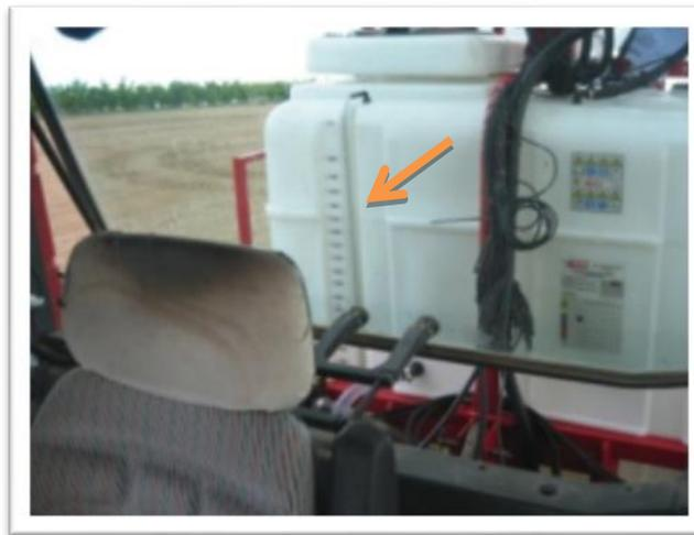
Fig 9 y 10: Existen diferentes indicadores de nivel. Se evaluará que sea visible para el conductor.
