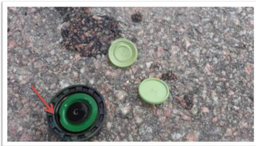
Fig. 23: Se observa una deformación en el dispositivo antigoteo que genera pérdidas.
