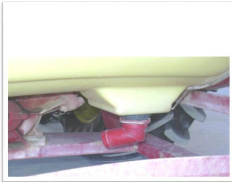
Fig. 11 y 12: El dispositivo de vaciado se encuentra en el punto más bajo del depósito.
