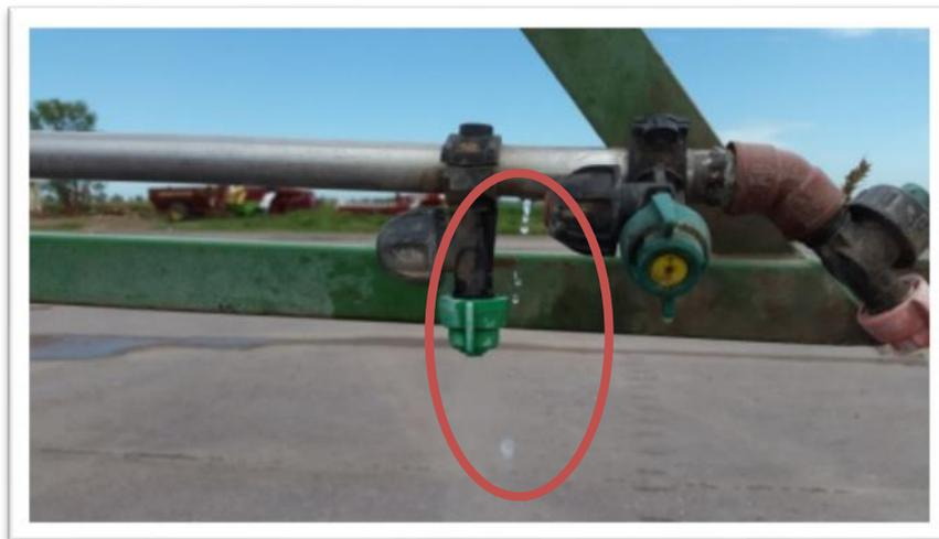
Fig. 24: No se certificará cuando se presenten fugas en las tuberías rígidas y/o en tuberías flexibles.
