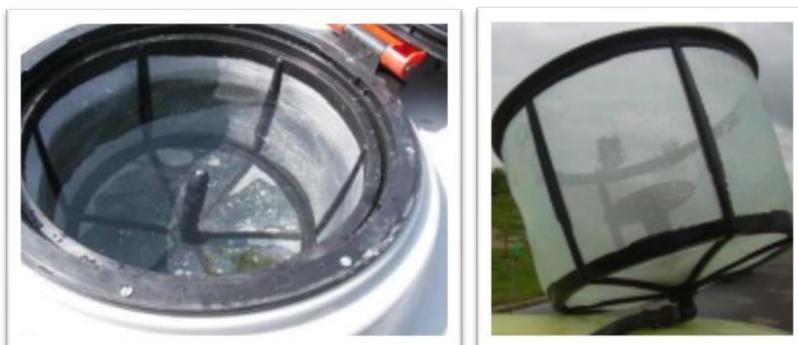
Fig. 15 y 16: Filtro en el orificio de llenado del tanque en condiciones.
