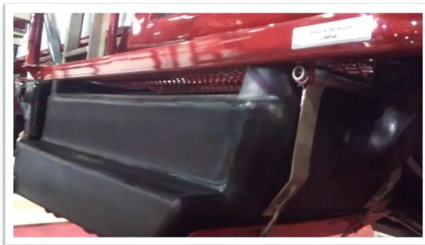
Fig. 18: Tanque de agua limpia identificado.
