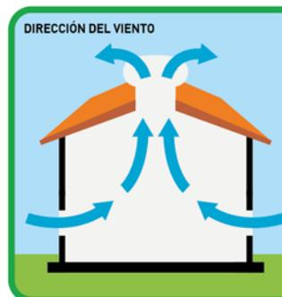
VENTILACIÓN DEL DEPÓSITO
